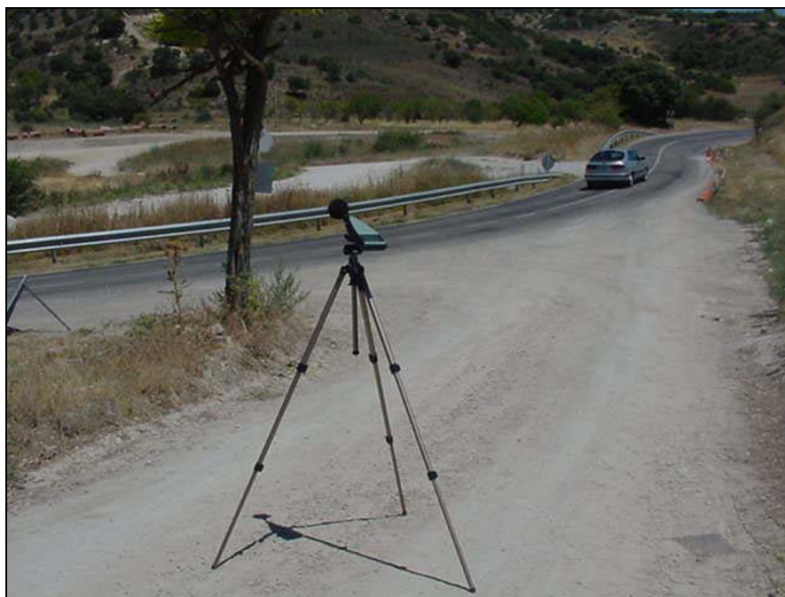
Fotografía 5. Medición de ruido en la carretera M-204, al sur del término municipal, Correspondiente con el punto P6
