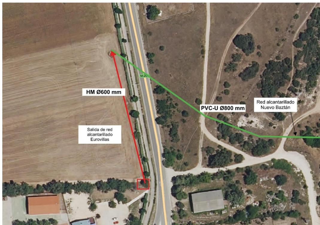
Imagen Salida de la red de alcantarillado de Eurovillas
